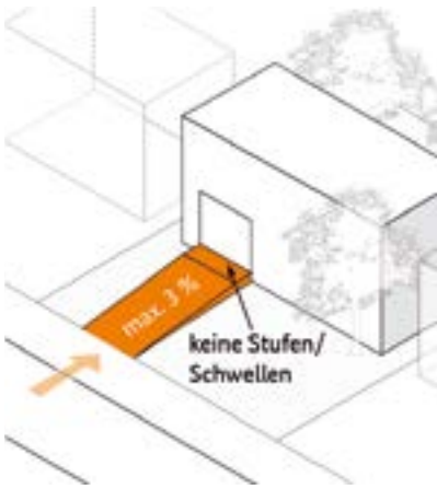
Topografische Situation zur barrierefreien Erreichbarkeit von Eingängen
